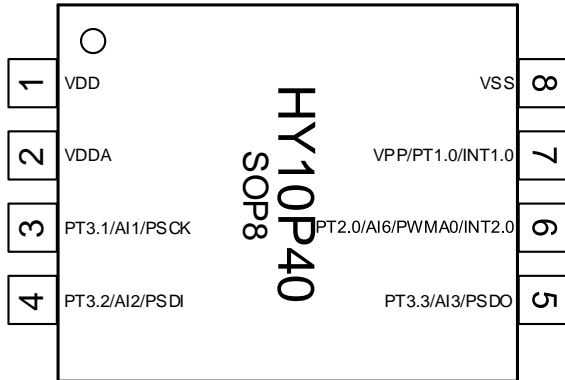
圖 2-1 HY10P40 SOP8 引腳圖
