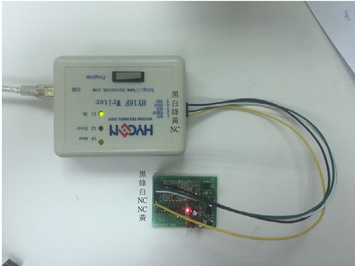
圖 9 HY16F184 Gas Sensor 與 USB 轉 I2C Board 硬體接線圖
